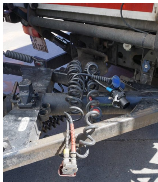
Abgelegte Verbindungsleitungen auf der Deichsel des Kofferanhängers (Foto: LAVG)
